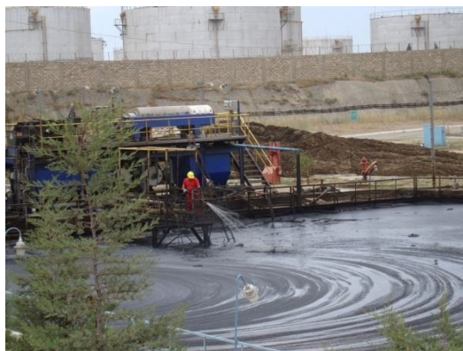
Рисунок 2 - Процессы выливания нефтяных сточных вод, образующихся после нефтепереработки
